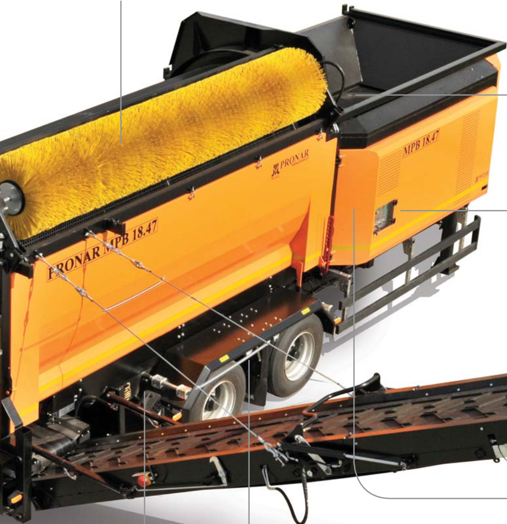
Щетка для очистки барабана - поднимается и опускается гидравлически
