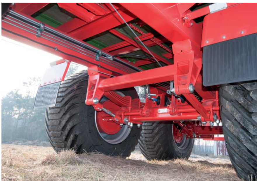
Шасси прицепа изготовлено из надежных и солидных замкнутых профилей, отличающихся очень высокой прочностью.
