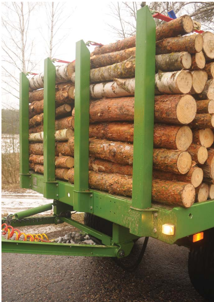
Благодаря возможности установки соответствующих элементов (стоек) прицепы приспособлены для перевозки бревен.
