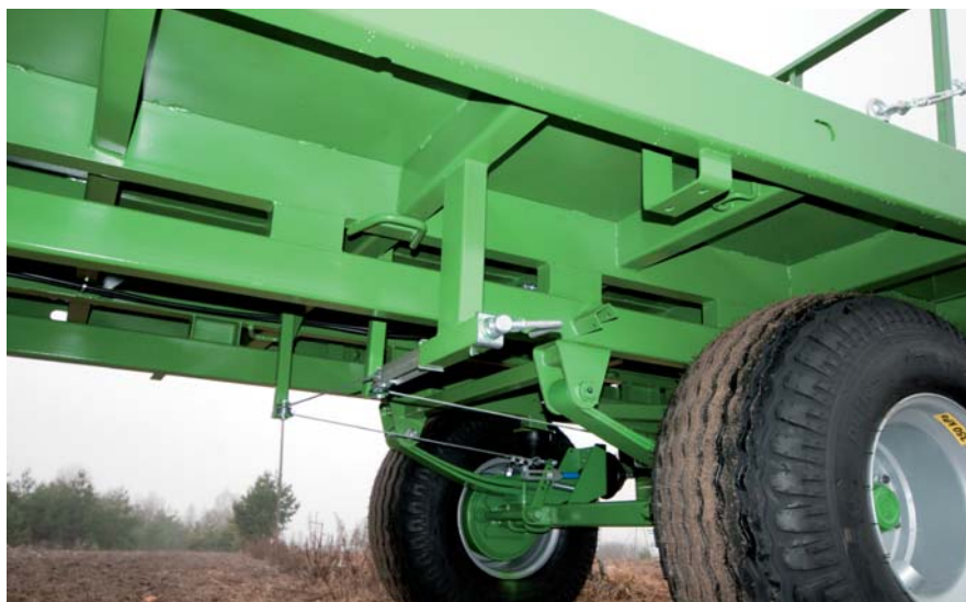
Новая грузовая платформа с упрочненным полом и профилированными боковыми рантами
