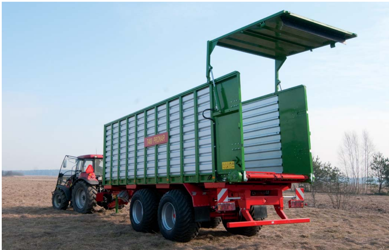
Объемный прицеп PRONAR T400 для перевозки биомассы
