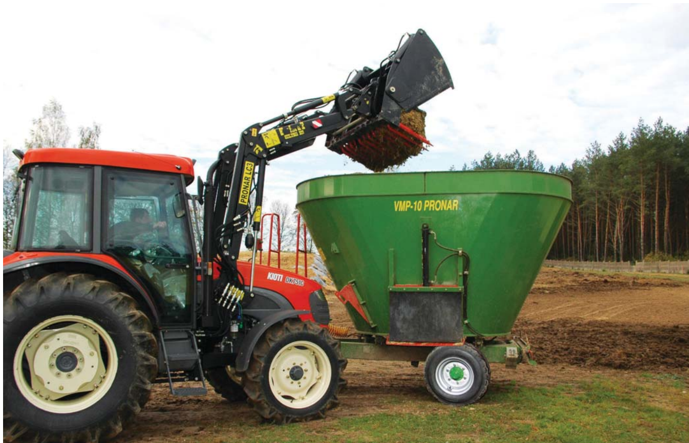
Базовая версия кормораздатчика VMP-10 вместимостью 10 м 3
