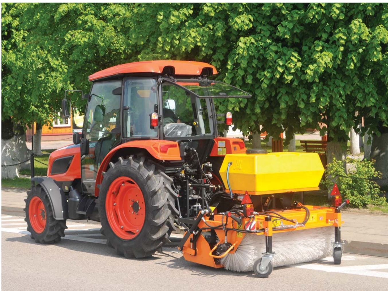
Подметательно - уборочная машина Agata ZM 1600 с трактором Kioti 4510
