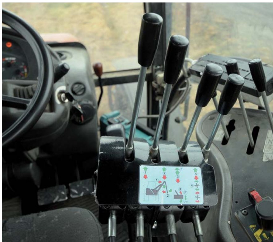
Всеми функциями стрелы управляет оператор при помощи специального пульта, размещенного в кабине трактора, с которым агрегируется машина.
