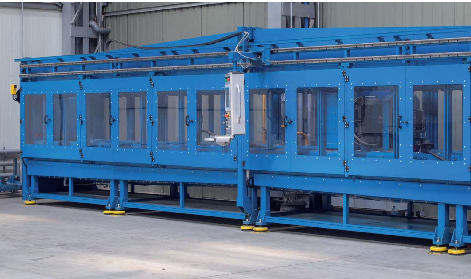
Уникальный стенд для испытаний и диагностики силовых гидроцилиндров.
