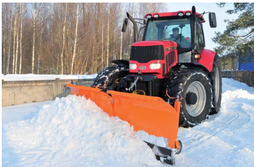
Каждый снегоотвал может работать в четырех положениях, за счет чего значительно повышается его функциональность
